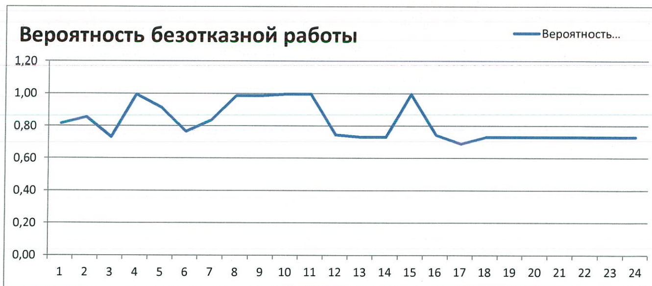
Рис.10.3.8.2. ВБР относительно ТК магистрального теплопровода ЦТЭЦ- ТК-41по ул. Курако Центральный район (расчетный путь 8)
