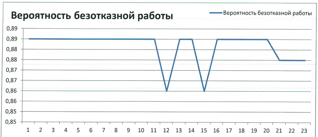
Рис.10.3.4.2. ВБР относительно ТК магистрального теплопровода ТК13 ул. Дружбы - ТК- 10 ул. Тольятти Центральный район (расчетный путь 4).
