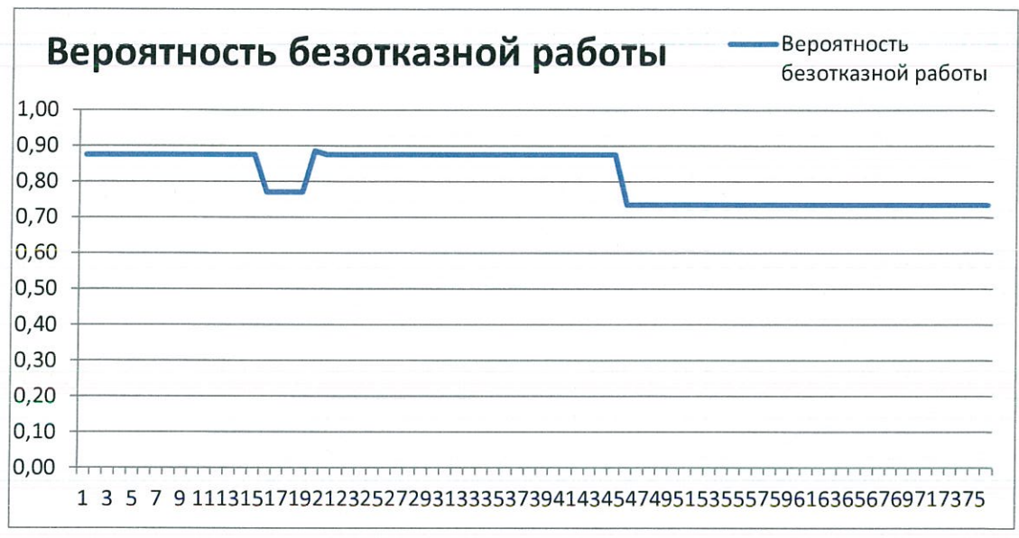
Рис.10.3.1.2. ВБР относительно ТК магистрального теплопровода КТЭЦ - ТК-60 по ул. Обнорского (расчетный путь 1)
